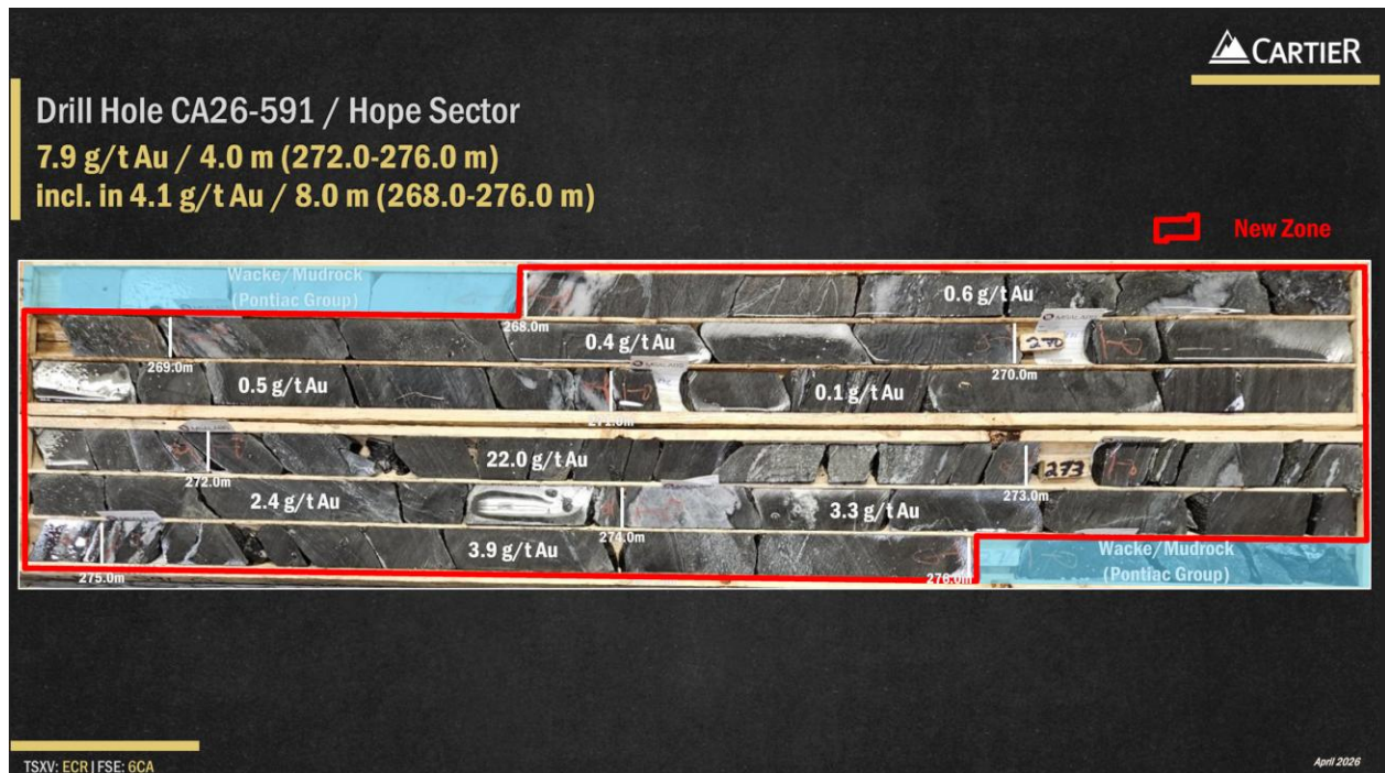
Figure 3 : Photos des carottes minéralisées du forage CA26-591
